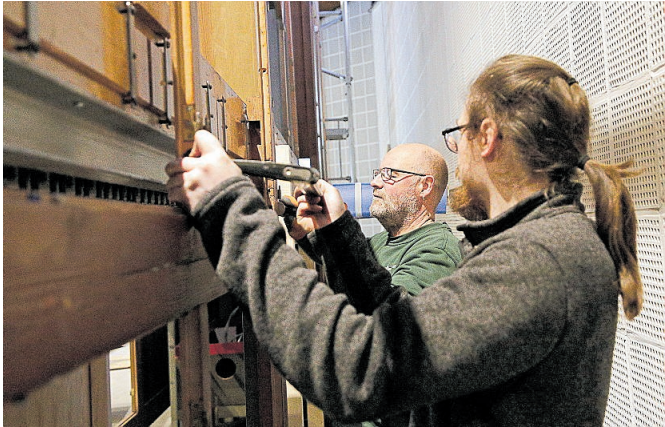
Ralf Freise (hinten) und Lars Boenigk von der Firma Fleiter justieren das Gerüst der Orgel.
